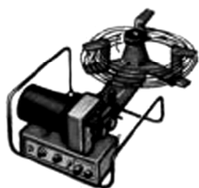
3-rasm. Kukunli simlar uchun sim uzatish mexanizmi.
